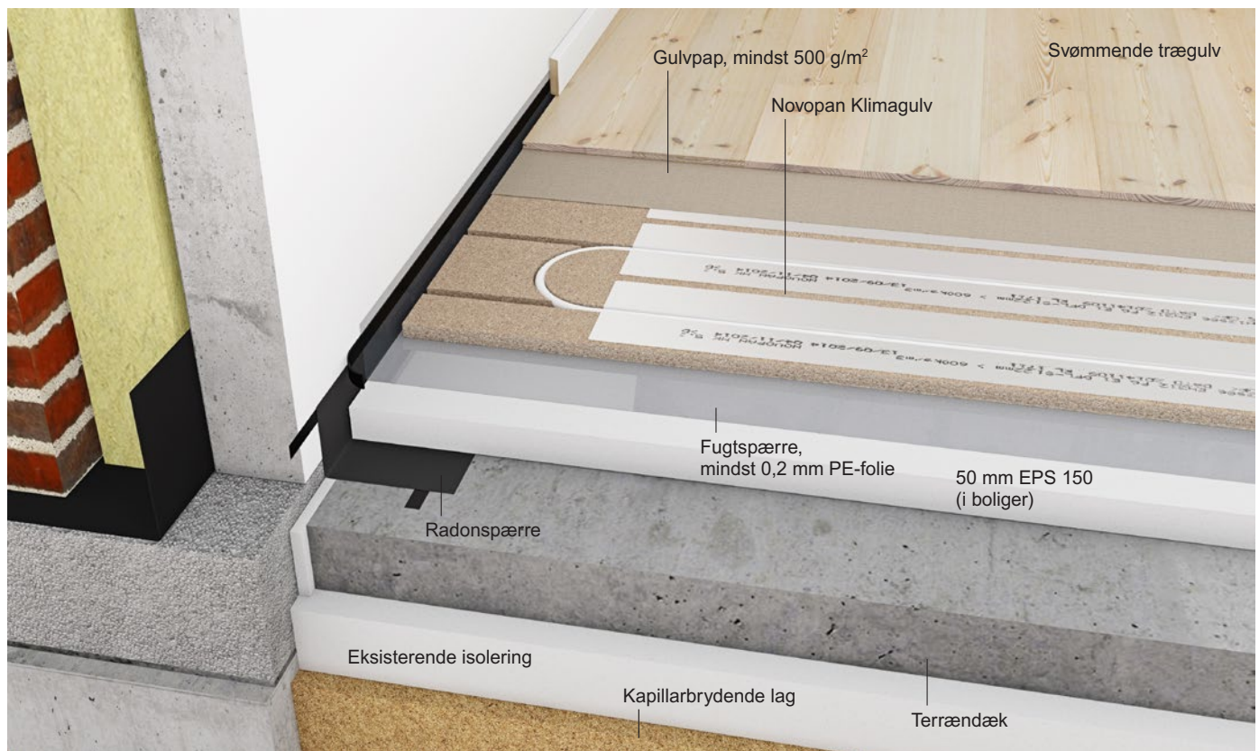
Figur 1 Novopan Klimagulv lagt svømmende på et ældre terrændæk med EPS-isolering og afsluttet med et svømmende trægulv.
